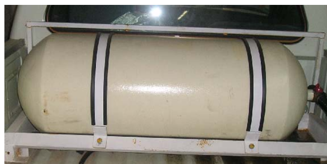
مخزن و اتصالات آن در پشت خودروی وانت
