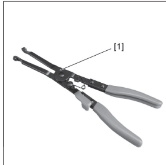
[۱] ابزار تعویض بست حلقوی لوله اگزوز با کد اختصاصی ۲۴۴۳۳۰۰۵
