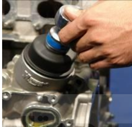
۹- درپوش فیلتر روغن را باز نمائید و اقدام به خارج کردن فیلتر روغن کنید . ( آچار بکس ۲۷ )
