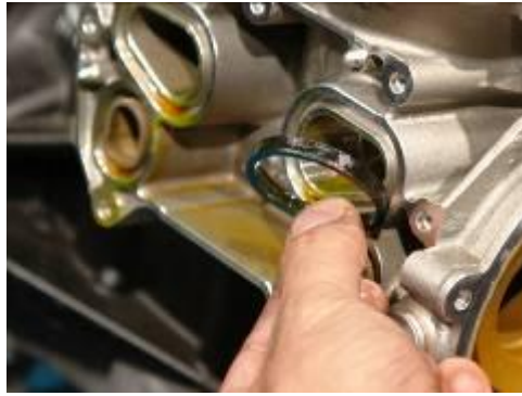
۹- درپوش فیلتر روغن را باز نمائید و اقدام به خارج کردن فیلتر روغن کنید . ( آچار بکس ۲۷ )
