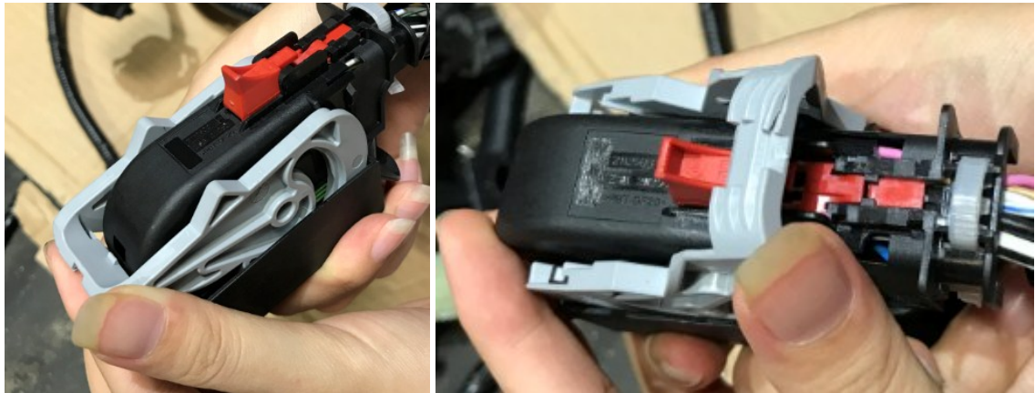
۲. سپس بست کمربندی طوسی رنگ را به عقب کشیده و کانکتور کنترل یونیت سیستم پایداری را آزاد کنید.
