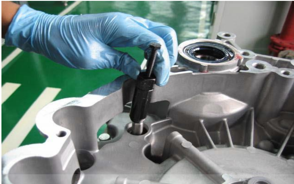
شکل ۴-۱: قرار دادن ابزار (480127) روی دسته دنده
