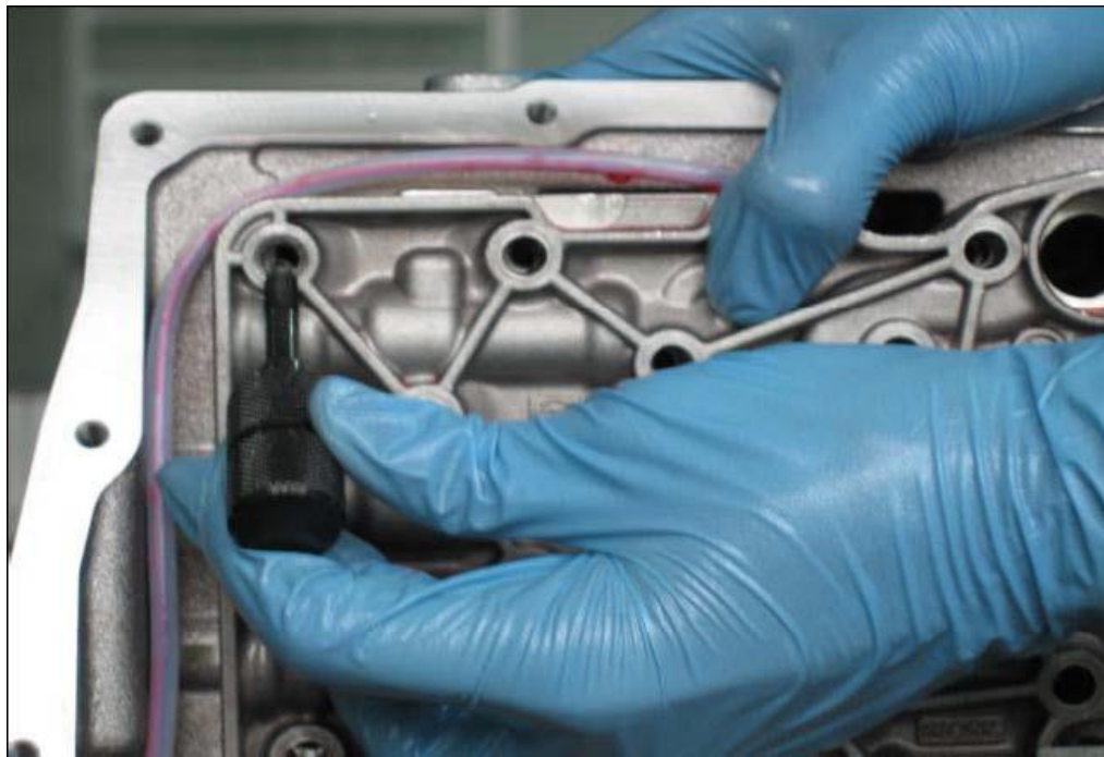
شکل ۶-۱۲: ابزار مخصوص (23K002-099-84312) ثابت کننده جعبه کنترل هیدرولیکی
