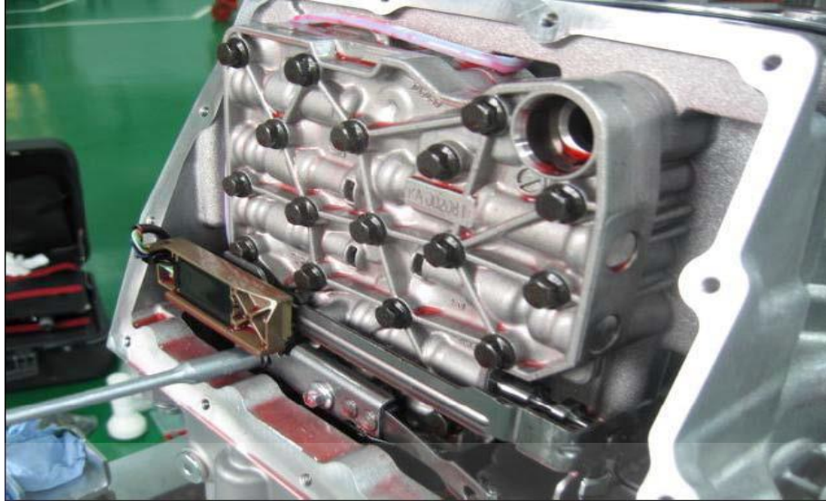
شکل ۱۱-۱: باز کردن پیچ سنسور وضعیت حرکت
