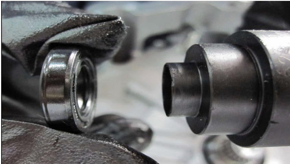
شکل ۴-۵: نصب کاسه نمد روی پانچ (480125)
