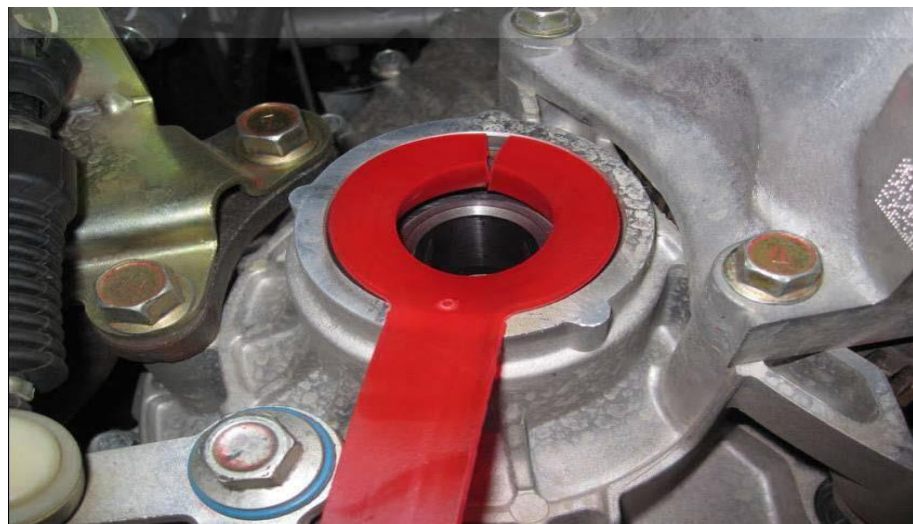
شکل ۱-۲: نصب ابزار 480145 میل پلوس
