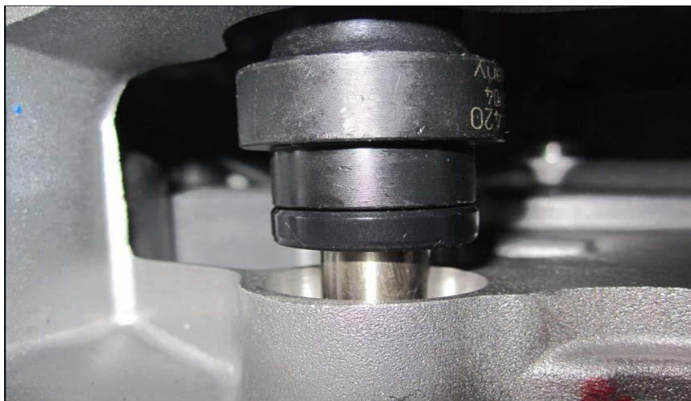
شکل ۷-۴: ضربه زدن به پانچ (480125) توسط چکش در محل مناسب
