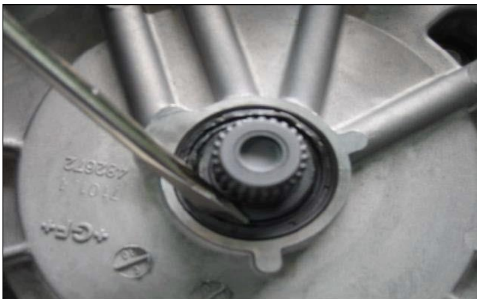
شکل ۱-۳: باز کردن کاسه نمد شفت داخلی
