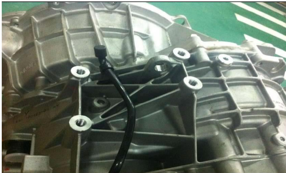
شکل ۳-۱۶: نصب بست و کلاهیک لوله تهویه
