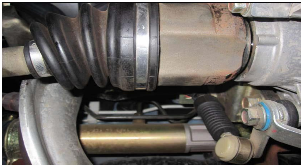
شکل ۶-۱: پلوس به طور کامل نصب شده است
