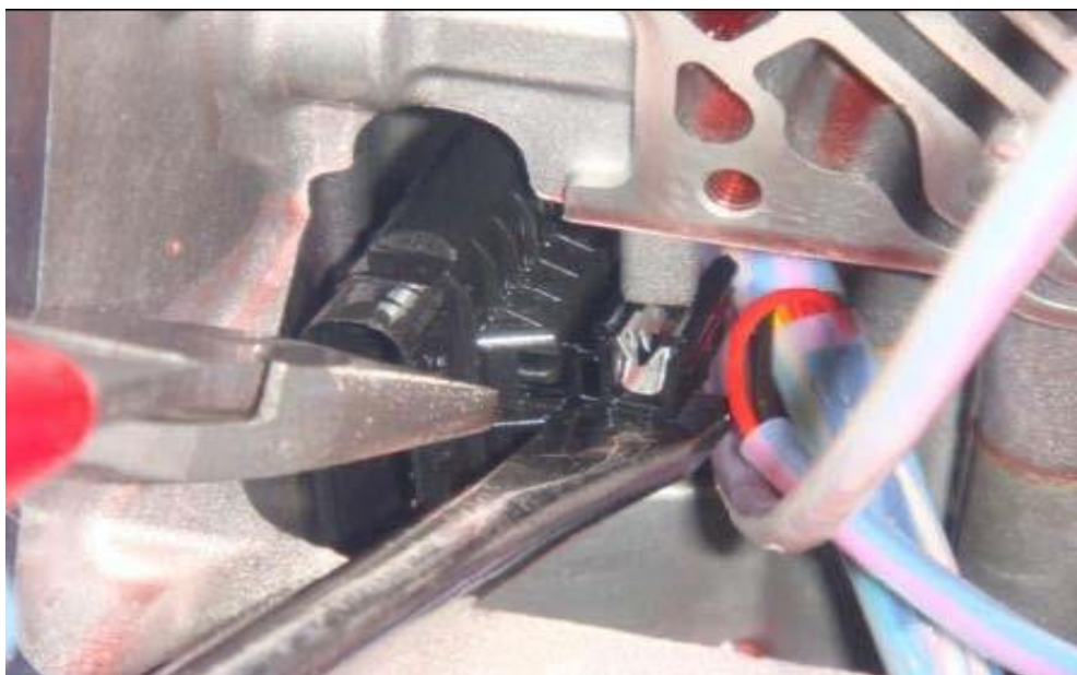
شکل ۶-۱۵: فشار دادن بست سنسور وضعیت حرکت در محفظه
