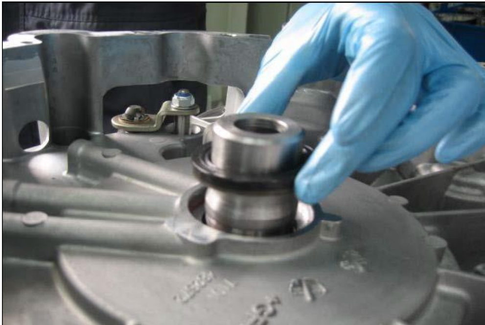
شکل ۳-۳: فشار دادن کاسه نمد به سمت پایین
