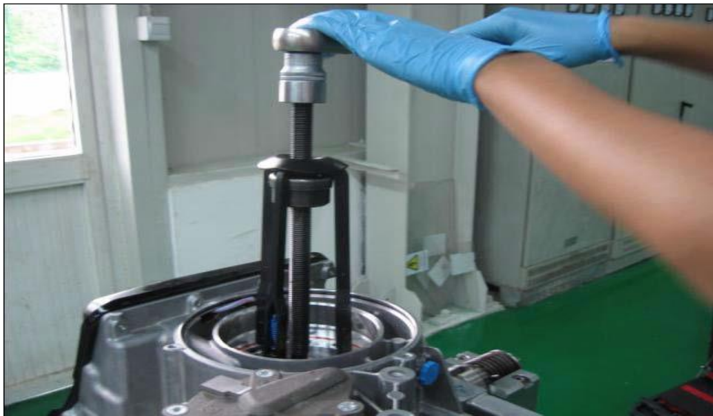
شکل ۵-۷: پیچاندن پیچ میانی برای بیرون آوردن بلبرینگ
