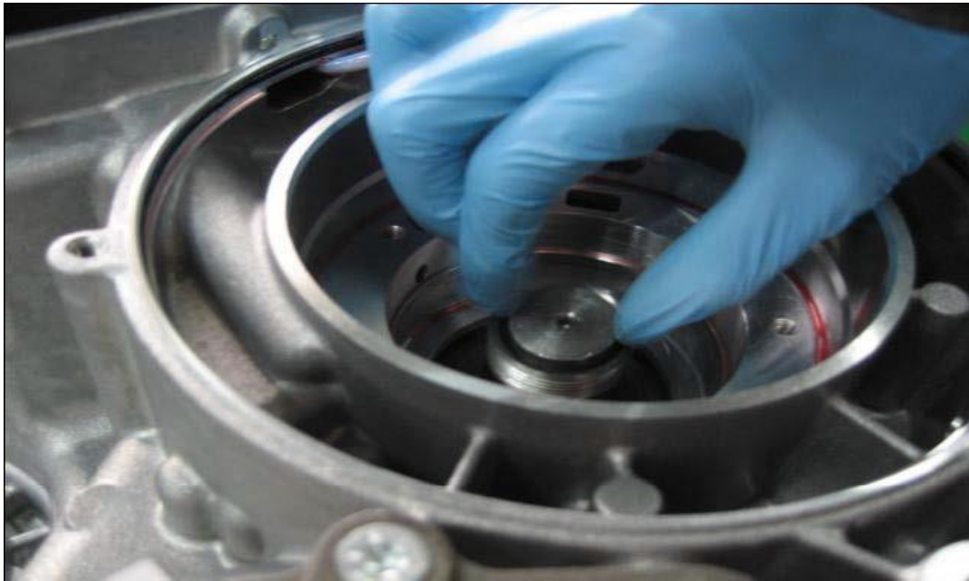
شکل ۷-۳: قرار دادن ابزار مخصوص روی شفت ( ابزار چرخ دنده مخروطی گردان T00222 )
