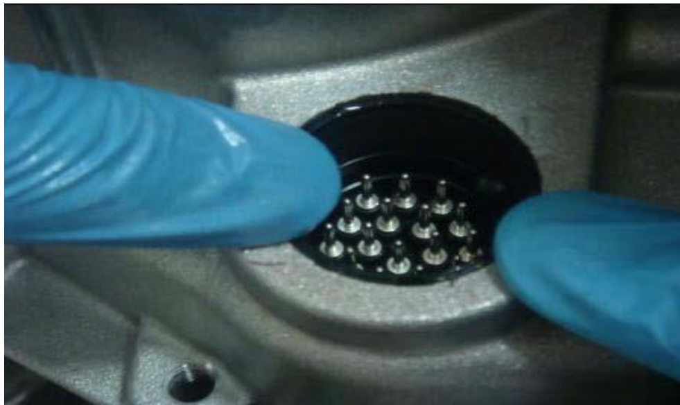
شکل ۱۵-۲: فشار دادن بست اصلی به داخل جعبه دنده
