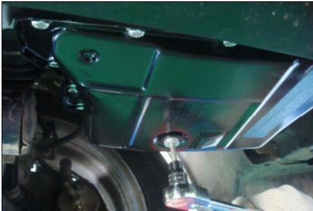
شکل ۹-۱: باز کردن پیچ تخلیه روغن
