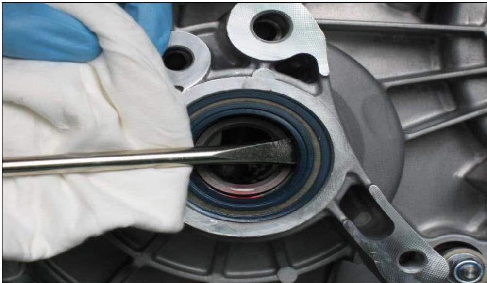
شکل ۱-۲: باز کردن کاسه نمد
