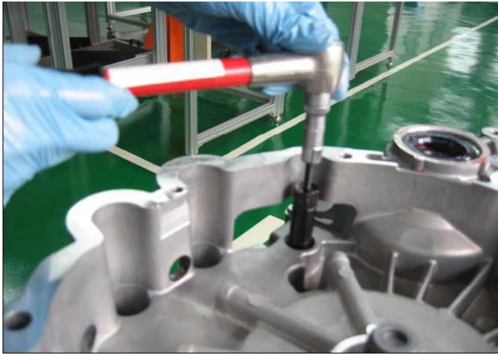
شکل ۴-۳: پیچاندن پیچ کوچک به منظور بیرون کشیدن کاسه نمد
