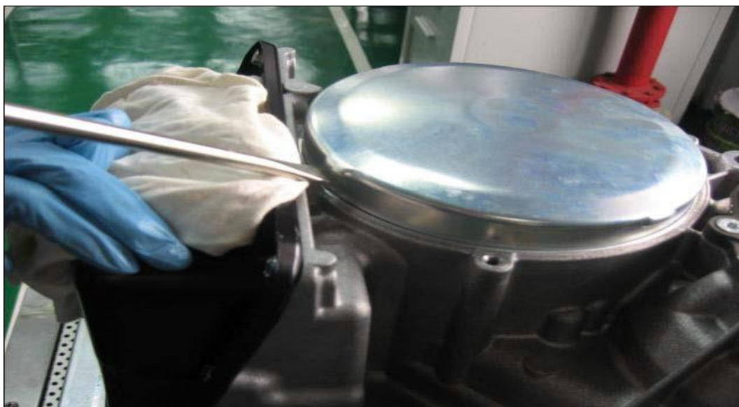
شکل ۱-۵: باز کردن قاب چرخ دنده مخروطی گردان
