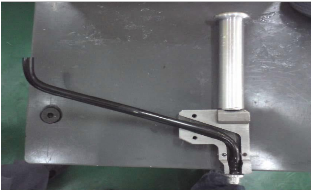
شکل ۱-۱۶: قرار دادن لوله تهویه در ابزار مخصوص
